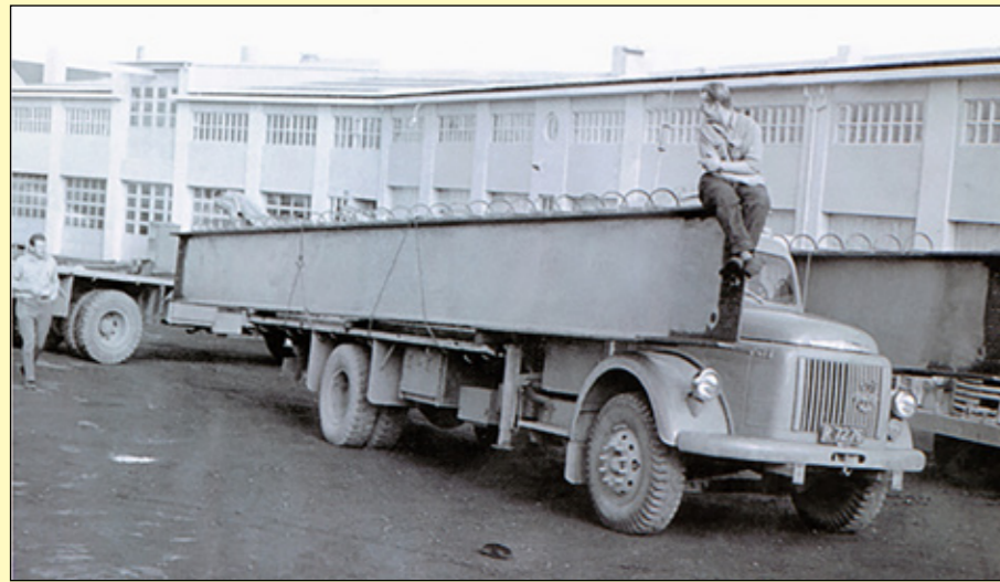
Volvo árgæð 1961, R 7276 í porti Vegagerðarinnar í Borgartúni 5, vorið 1962, með bita fyrir Fnjóskárbrú í Dalsmynni, Suður-Þingeyjarsýslu. Baldur Kristensen á gangi fyrir aftan bílinn. Hægt var að komast inn í bílinn í gegnum lúga á þakinu en ekkert sást til hliðanna.
